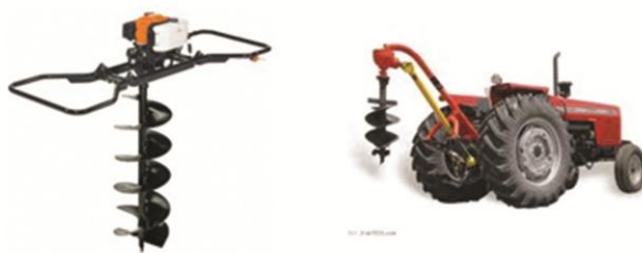
شکل ۴ - چاله‌کن موتوری تراکتوری (راست) و موتوری دستی (چپ)
